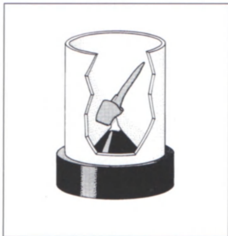
Рис. 13-63. Пластмассовая модель с литниковым штифтом в опоре готова для формования
