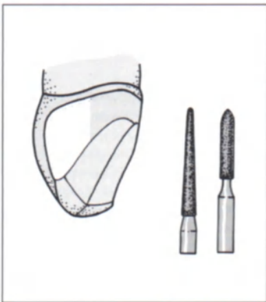
Рис. 11-23. Препарирование проксимальной осевой поверхности: длинные шиловидный и торпедовидный алмазные боры
