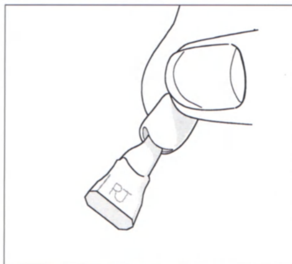
Рис. 24-14. Колпачок легко снимают со штампа, который дал усадку в процессе термической обработки
