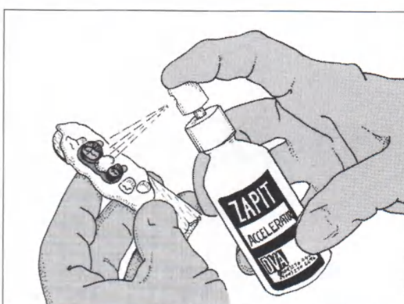
Рис. 27-59. На соединение наносят спрей катализатора Запит
