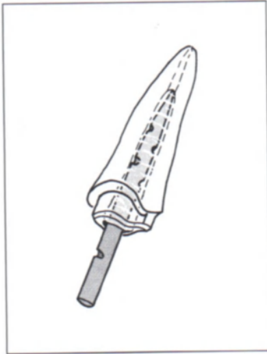
Рис. 13-59. Пластмассовый литниковый стержень шлифуют, чтобы он свободно располагался в канале
