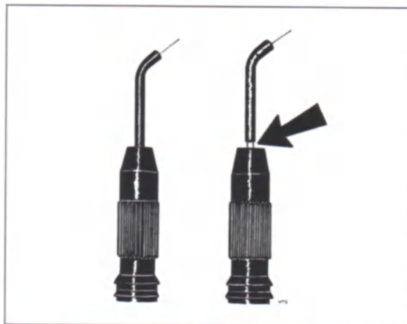
Рис. 16-32. Электроды должны быть полностью установлены в наконечнике (слева). Контакт с оголенным металлом, кроме кончика (стрелка), может привести к ожогу пациента или стоматолога
