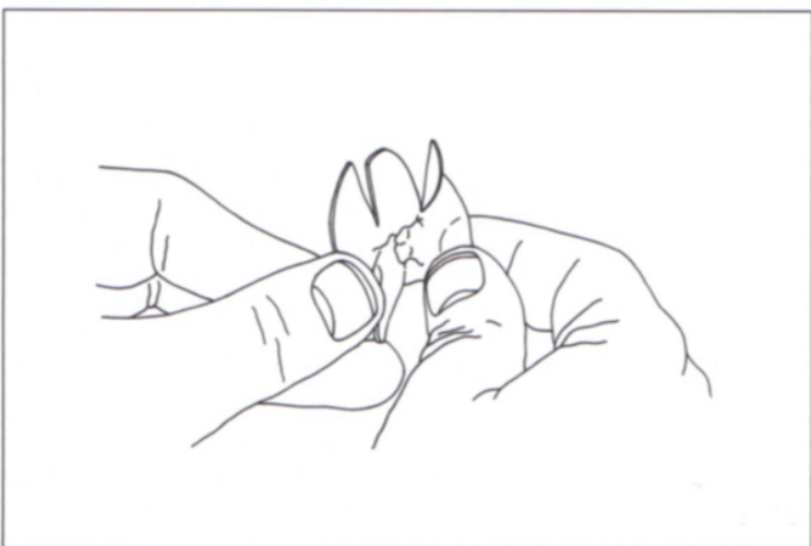
Рис. 25-29. Из колпачка извлекают компенсационный диск
