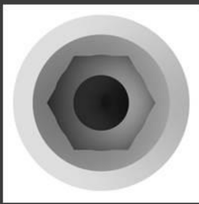
Внутренний шестигранник: Zimmer Screw-Went, MIS, Biohorizons, Alpha-bio., Implant Direct, AB, Avinent, BSB и т.д.
