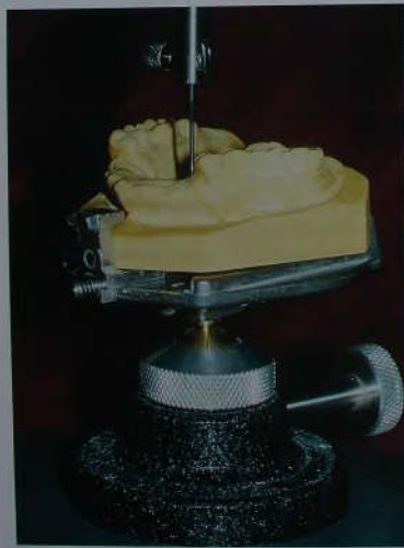
Рис. 22-17. Чтобы определить адекватность зоны поднутрений на мезиальных поверхностях передних опорных зубов и на дистальных вестибулярных поверхностях боковых зубов, модель сначала изучают при наклоне 0°. Это положение регистрируют с помощью отметок на коколе модели.
