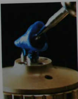
Рис. 14-18F. Процесс фрезеровки выполняется так же, как и при изготовлении вкладок и накладок. Модель устанавливается на левой, сдвигающейся стороне машины.
