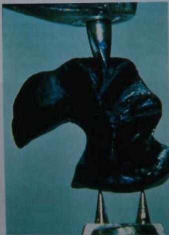
Рис. 14-18В. Затвердевшую восковую модель помещают в левую, сканирующую часть Celay машины. Для фиксации в машине моделей различного размера и формы существуют адаптеры разной конфигурации.
