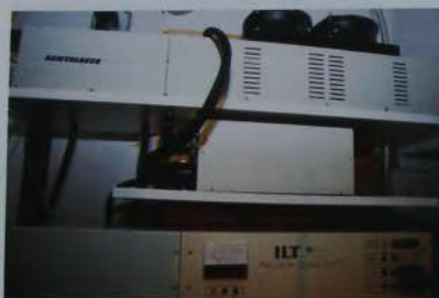
Рис. 13-14 Н. Основным преимуществом аргоновой системы является быстрая полимеризация (5-10 секунд). На снимке показаны два установленных в центре кабинета прибора для аргоновой полимеризации, что позволяет работать с ними нескольким врачам одновременно (Dentalaser, Premier Laser Systems; Precision Curing Unit, ILL, Salt Lake City, UT).
