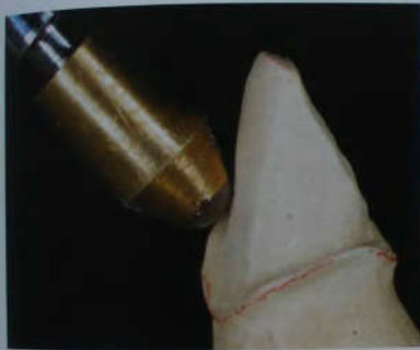
Рис. 15-15I. Насадка сканера исследует все поверхности зуба и передает полученные данные в компьютер. Затем устанавливается финишная граница обработки и толщина керамического каркаса коронки.
