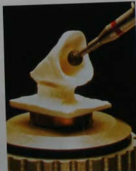
Рис. 14-18G. После установки модели на левой стороне машины начинается вытачивание колпачка коронки на правой стороне машины. Для точного воспроизведения модели используется несколько новых инструментов, специально разработанных для изготовления коронок и мостов.
