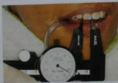
Рис. 13-6F. Для измерения и вычисления правильных пропорций и размеров новых реставраций использовали стоматологический штангенциркуль со шкалой (Masel Orthodontics, Bristol, PA).
